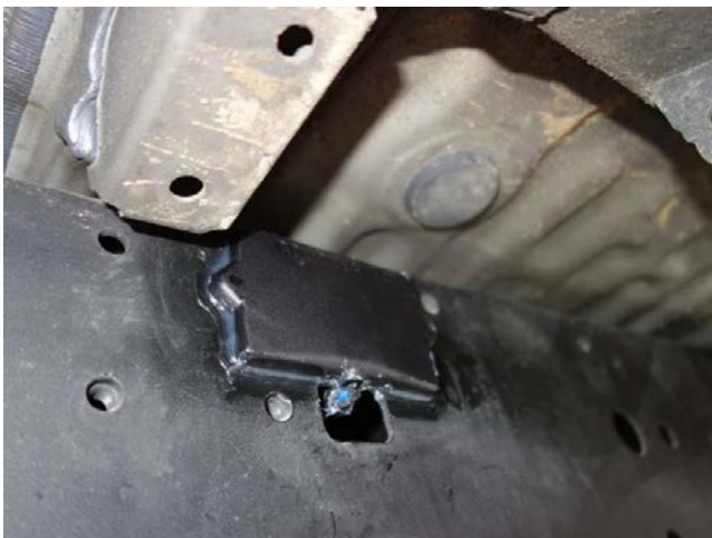
Dichtungskappe sauber verklebt und abgedichtet.
